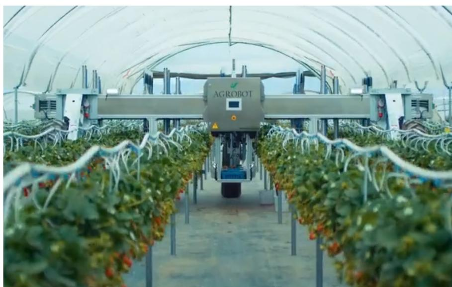
图 1.1 Agrobot 团队研制的草莓采摘机器人
