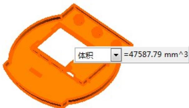
借助于 ug 软件，直接测量出单个塑件的体积  $V=47.5\text{cm}^3$ ，质量  $M=\rho V=1.06\times 47.5=49.8\text{g}$ 。
