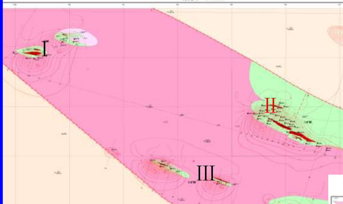
格尔木市尕林格铁矿区东段基岩地质略图(附:磁异常
