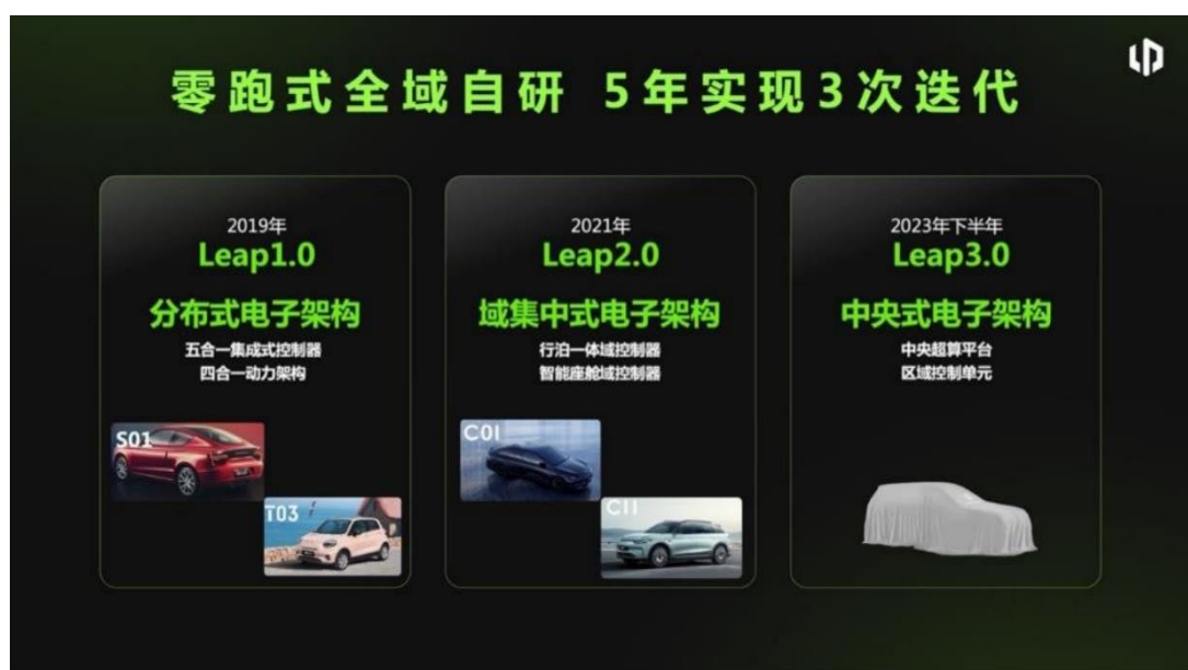
图表11：零跑 LEAP 架构迭代情况
