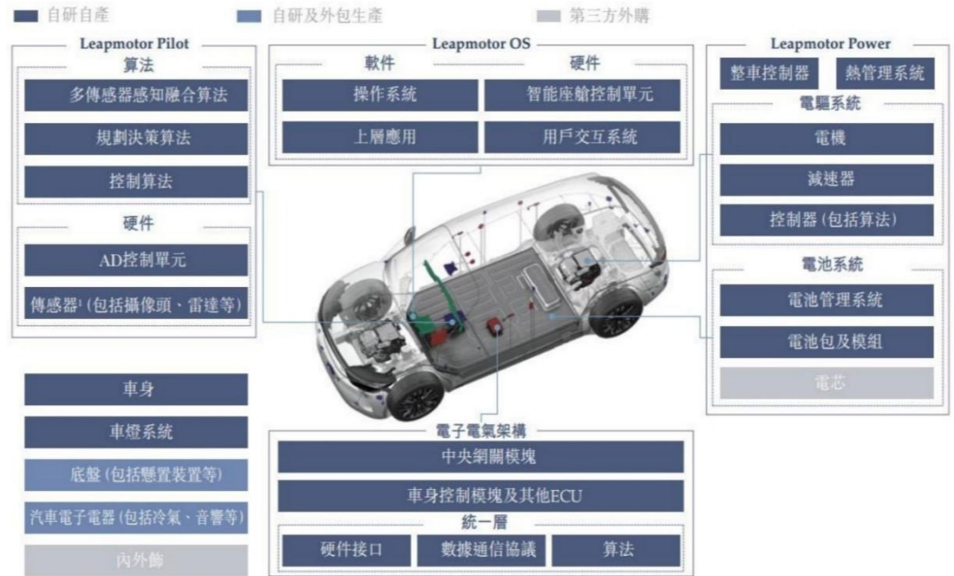
图表10：零跑汽车全域自研示意图
