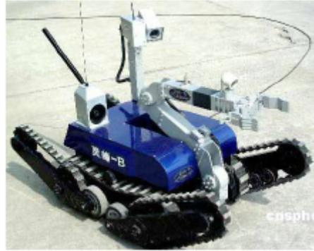
以上两种机器人采用的是给主车体添加一种前摆臂，机器人通过调节摆臂关节角度适应地面的变化。越障过程中不断调解前摆臂的角度，来实现对阶梯的翻越。但由于加了摆臂，驱动控制起来就有点复杂，不仅要给机体自身施加动力，并且关节处尚有施加相应的驱动。特别是前臂何时抬起，抬起到什么角度，需要多大的力，都需要进行精确的计算。这样关节式履带机器人往往造价较高，无法普及，不符合我国国情。
