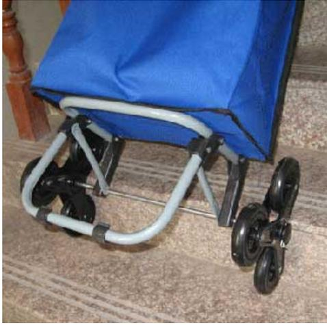
这种常见的用于上下楼梯的行李车就是采用了三角式的行星装置。我们受此启发，集合行星轮与履带，发明出了这种行星履带式的行走机构。
