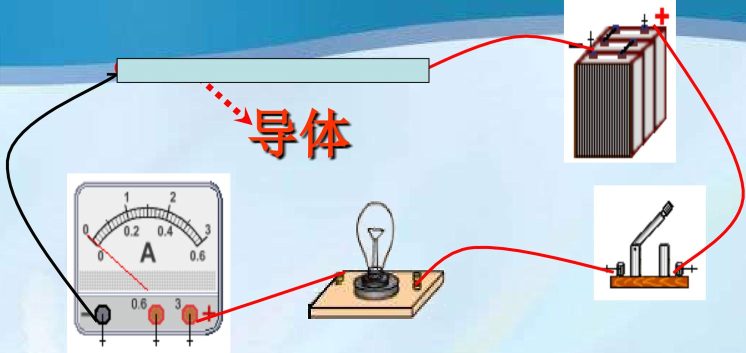
改变导体的电阻会引起电流的变化，从而改变灯的亮度
