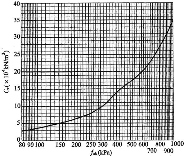
图 3.3.2 天然地基的抗压刚度系数  $C_z$  与地基承载力特征值  $f_{ak}$  关系统计曲线
