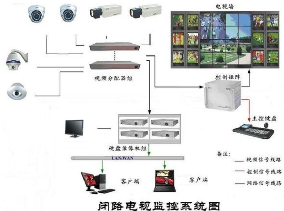
(图一.视频监控总体架构原理图)
