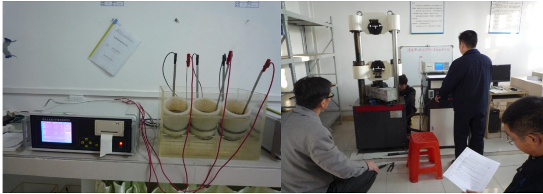
图 1 混凝土氯离子扩散系数测试 图 2 混凝土抗折及弯曲韧性试验
