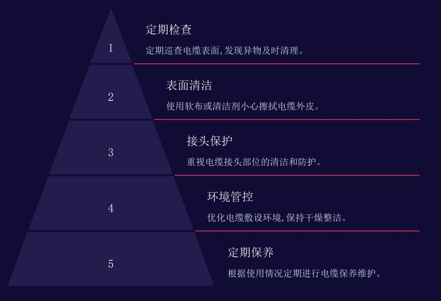
电缆清洁保养工作需要细致入微的操作。除了定期检查电缆表面是否存在污渍、异物附着等问题并及时清理外,还应注重电缆接头部位的清洁和防护,同时优化电缆敷设环境,保持电缆环境的干燥整洁。根据电缆的使用频率和环境条件,制定合理的定期电缆保养计划也非常重要。
