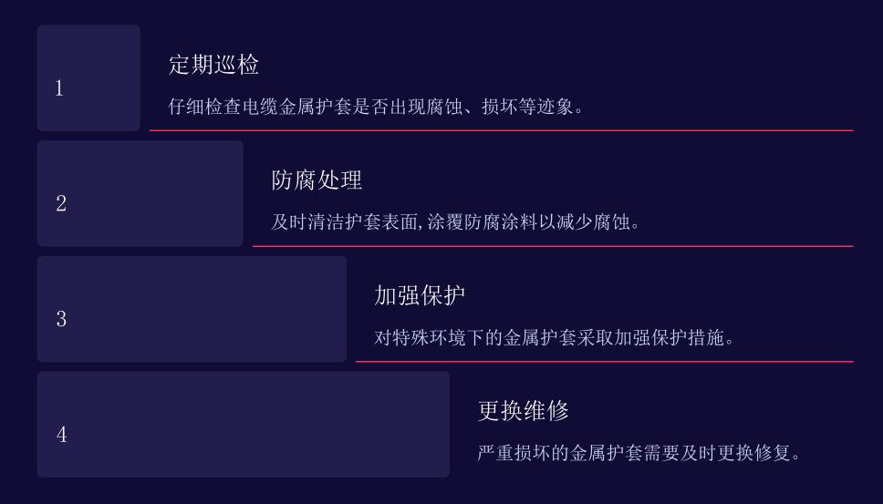
电缆金属护套是保护电缆免受外部机械损坏和电磁干扰的重要部件。因此电缆维护工作中需特别重视对金属护套的维护保养。首先要定期巡视检查护套表面是否出现腐蚀、损坏等情况,并及时进行清洁和防腐处理。对于特殊环境下的电缆,还要采取加强保护措施。一旦发现金属护套严重损坏,应立即进行更换维修。
