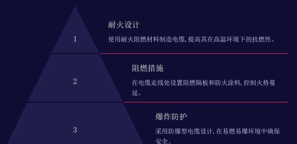
鉴于电缆可能面临火灾和爆炸等严重威胁,在电缆设计和敷设中必须严格考虑防火防爆的因素。首先要使用耐火阻燃材料制造电缆本体,提高其在高温环境下的抗燃性。同时在电缆走线的关键部位设置阻燃隔板和防火涂料,以控制火势的蔓延。对于易燃易爆环境下的电缆,还要采用防爆型设计,确保在发生火灾或爆炸时不会引发二次灾害。这些综合措施可以有效降低电缆自身引发火灾和爆炸的风险。
