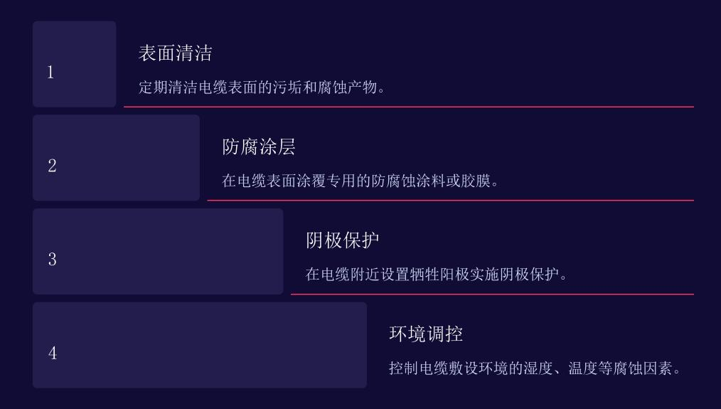
电缆防腐蚀处理包括定期清洁电缆表面、涂覆专用的防腐蚀涂层、采用阴极保护等措施。同时应控制电缆所处环境的温度、湿度等因素,减少腐蚀性因素的影响。这些综合措施可以有效延长电缆的使用寿命,确保电力系统的安全稳定运行。
