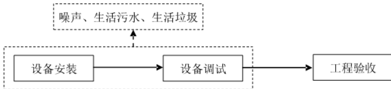
图2 施工期主要工艺流程及产污节点图
