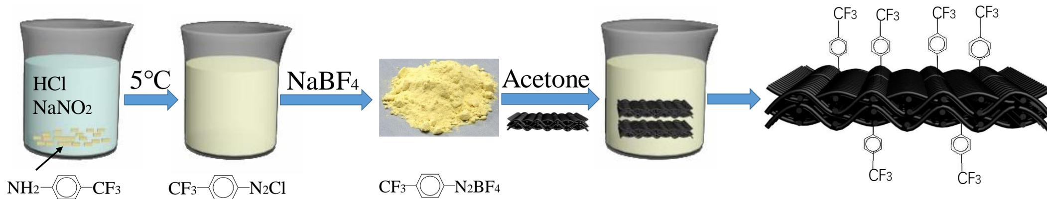
图3.2 A-CFF制备流程图
