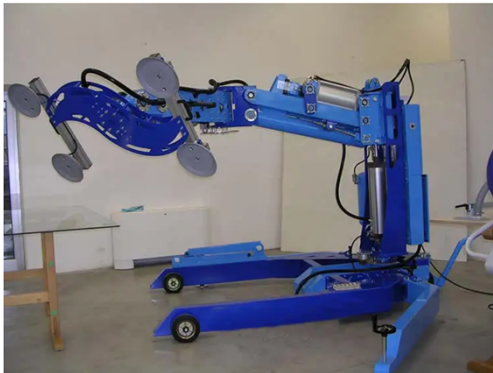
图 1.3 可移动式吸盘机械手结构示意图
