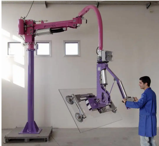
图 1.2 辅助搬运机械手结构示意图
