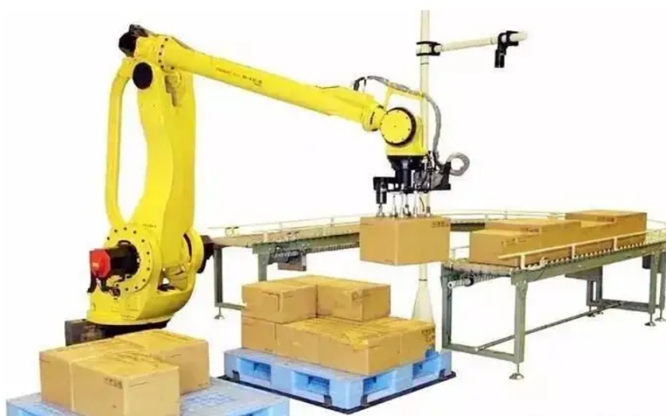
图 1.1 吸盘式物料分拣机械手结构示意图
