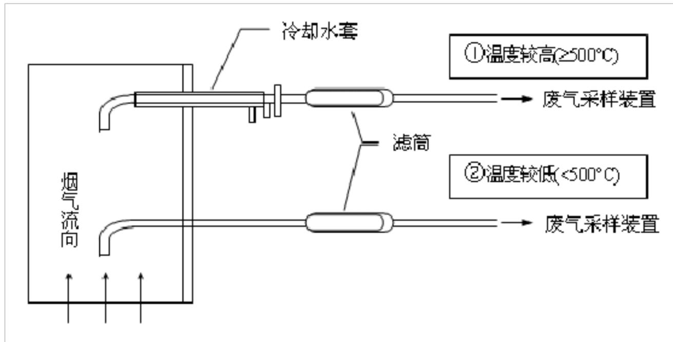
图 1 采样管和滤筒托架
