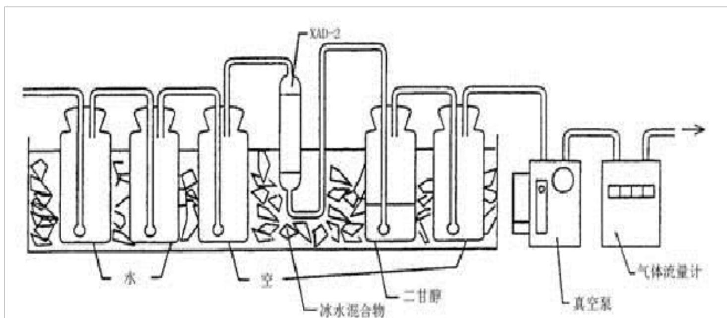
图 2 废气采样装置示意图
