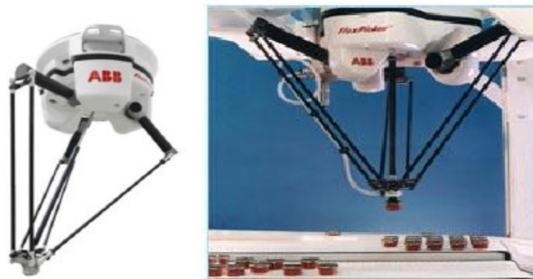
图 1.1 IRB360 FlexPicker 对流水线上的食品进行分拣
