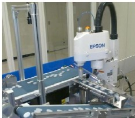
图 1.3 爱普生工业机器人对流水线上的物体进行视觉分拣
