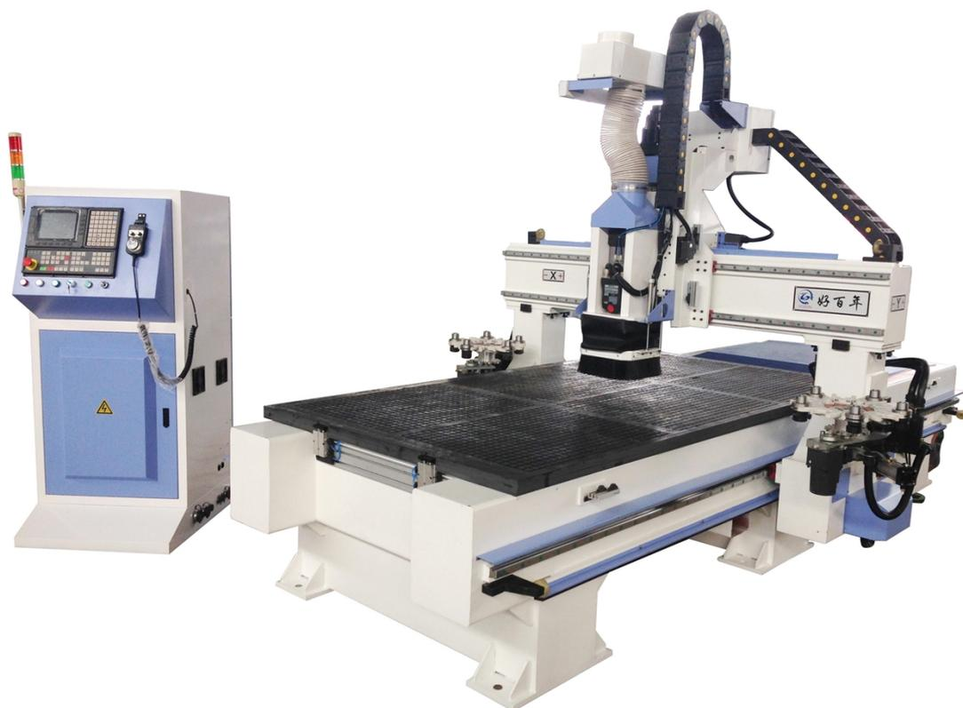
雕刻机矢量控制技术模仿直流电动机的控制，以转子磁场定向，用矢量变换的方法来实现驱动和控制，具有良好的动态性能。矢量控制驱动器在刚启动时具有很大的转矩值，加之电主轴本身结构简单，惯性很小，故启动加速度大，可以实现启动后瞬时达到允许极限速度。这种驱动器又有开环和闭环两种，后者可以实现位置和速度的反馈，不仅具有更好的动态性能，还可以实现 C 轴功能 而前者动态性能稍差，也不具备 C 轴功能，但价格较为便宜。
