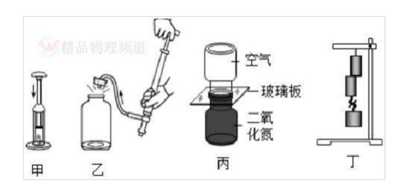
A. 甲图: 活塞压缩空气,硝化棉燃烧, 过程与热机压缩冲程原理相同
