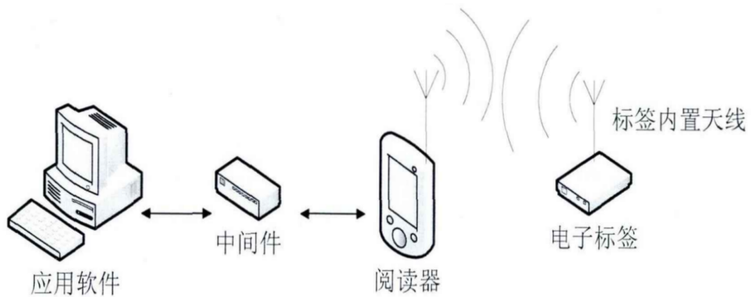
图 3.1 RFID 工作原理图
