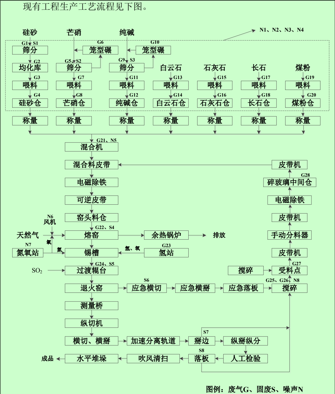
图 1 现有工程浮法玻璃生产工艺流程及排污节点图
