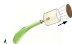
A. 电火花发生器点火后将盒盖顶出
