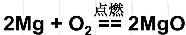
常温下即可反应，点燃产生耀眼的白光，生成白色固体，可用于燃烧弹和照明弹。
