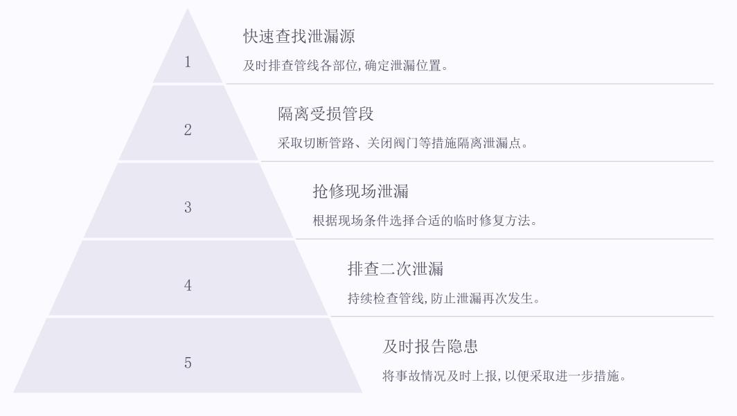
在高温环境下发生管道泄漏事故时,必须快速找到泄漏源头。首先要隔离受损管段,切断管路或关闭阀门等。接着根据现场条件采取临时修补措施。同时持续检查管线,防止泄漏再次发生。最后要及时上报事故情况,以便管理部门采取进一步的应急处理。只有这样才能有效控制泄漏,避免事故扩大。
