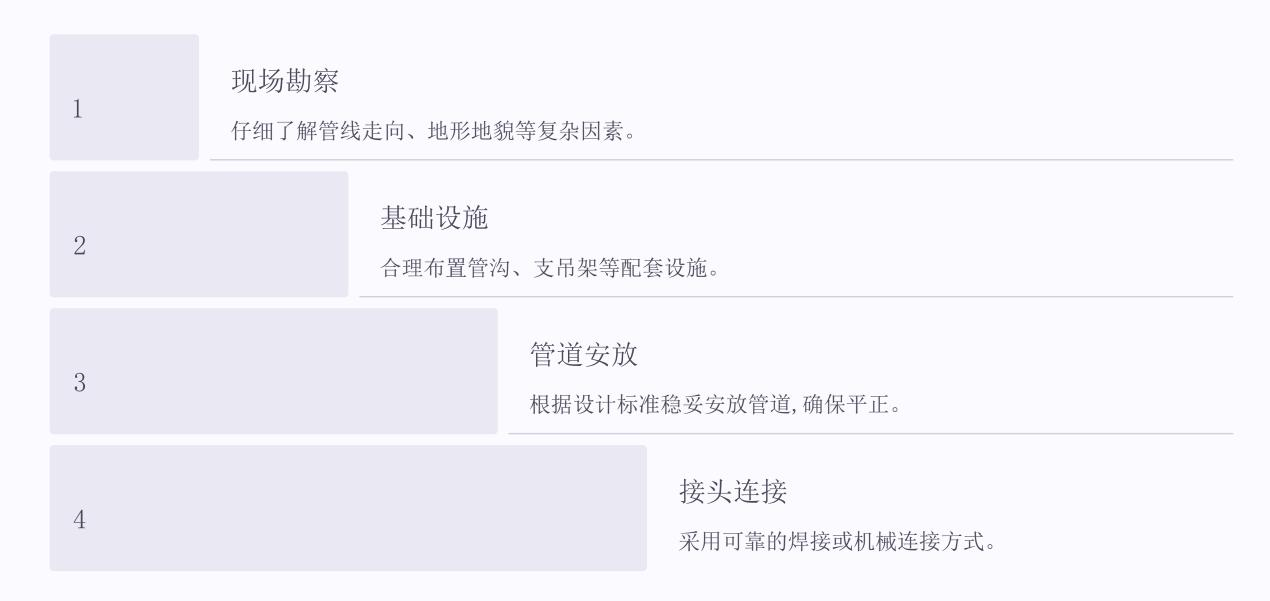
在高温环境下的管道敷设过程中,需要严格按照施工图纸和技术标准进行现场勘察和基础设施的建设。合理规划管沟布置,采取专业的安放和接头连接方式,确保管道在高温下的平稳运行。
