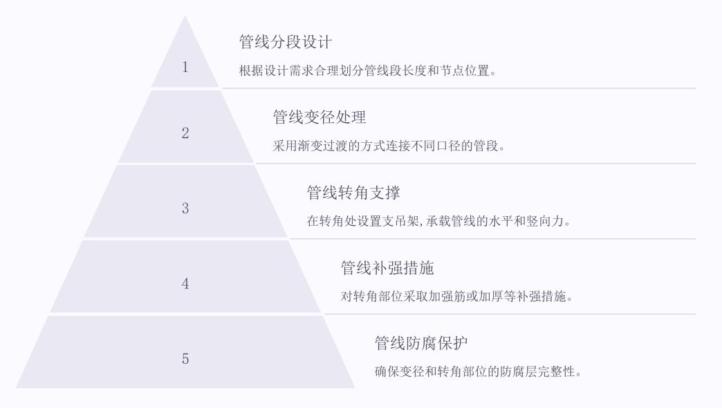
在高温环境下进行管道施工时,管线的变径和转角处理是关键。首先要根据设计需求合理划分管线段长度和节点位置。对于管径的变化段,采用渐变过渡的方式进行连接。在转角部位设置支吊架,承载管线的水平和竖向力。同时还要对转角部位采取加强筋或加厚等补强措施,并确保防腐层的完整性。只有采取这些措施,才能确保管线在高温条件下安全稳定运行。
