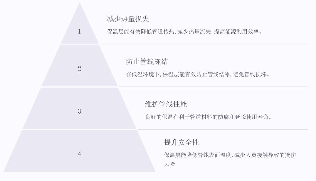
在高温环境下,管道保温是确保管线安全稳定运行的关键。完善的保温措施不仅能有效减少热量损失,还能防止管线冻结、延长使用寿命,同时也提升了整体的安全性。因此,管道保温环节应引起高度重视,采取切实可行的保温技术。
