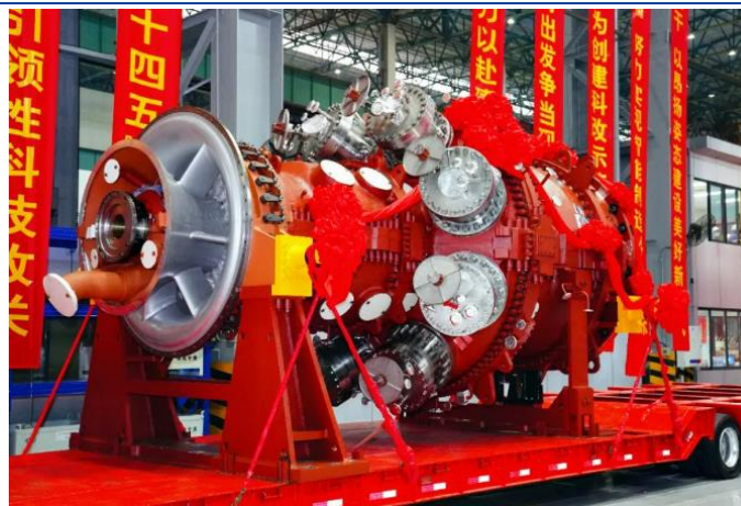
图表41: 国内首台自主研发F级50MW重型燃机
