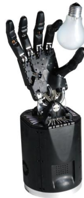
图2: shadow hand使用腱绳驱动
