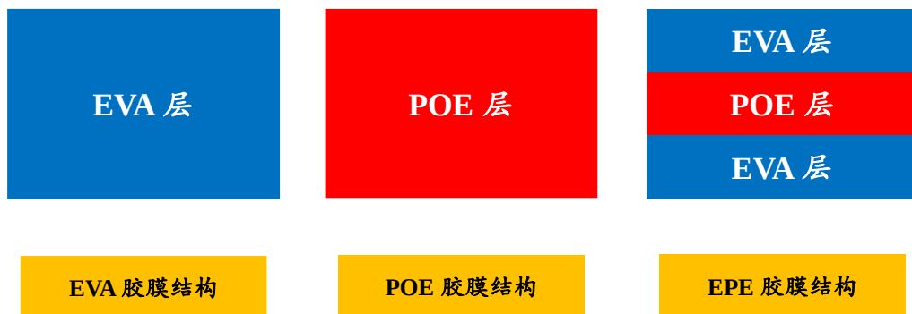
图30：光伏封装胶膜主要包括 EVA 胶膜、POE 胶膜、共挤型 POE 胶膜
