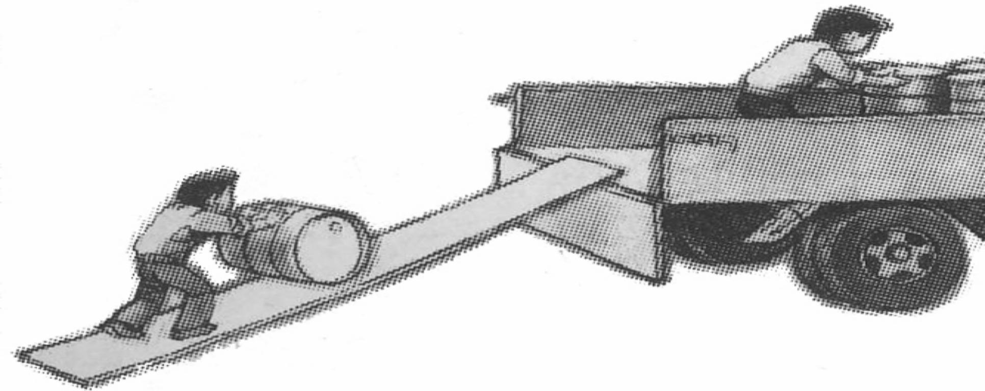
像搭在汽车车厢上的木板那样的简单机械，叫做斜面。
