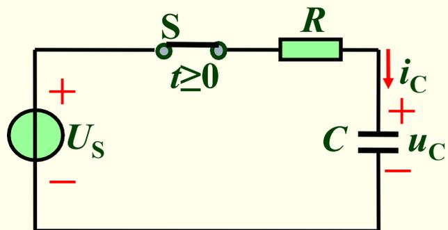
由RC零状态响应电路图可得过渡过程结束时电容的极间电压(即换路后的新稳态值)
