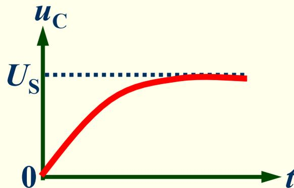
电容元件也是储能元件，其电压、电流在任一瞬间也遵照微分(或积分)的动态关系。它储存的电能：
