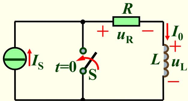
左图所示电路在换路前已达稳态。 $t=0$ 时开关闭合，之后电流源不起作用，暂态过程在 $R$ 和 $L$ 构成的回路中进行，仅由 $i_L(0+) = I_0$ 在电路中
