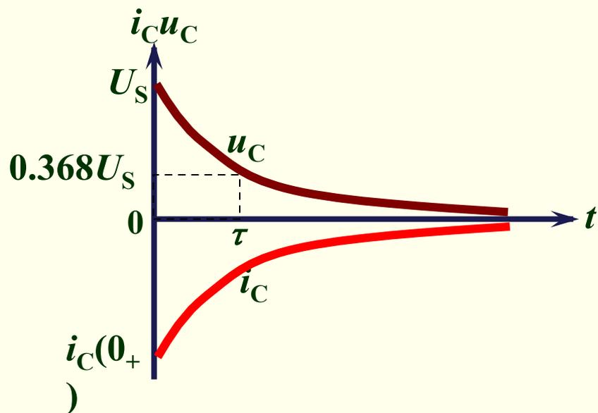
RC过渡过程响应的波形图告诉我们：它们都是按指数规律变化，其中电压在横轴上方，电流在横轴下方，阐明两者方向上非关联，电容放电电流为：
