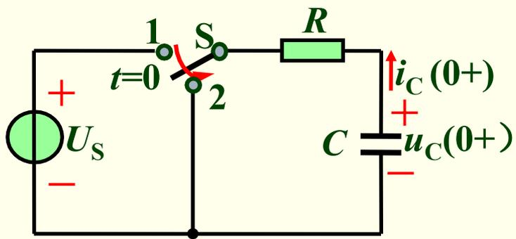
左图所示电路在换路前已达稳态。 $t=0$ 时开关由位置1迅速投向位置2，之后由 $u_C(0+)$ 经 $R$ 引起的电路响应称为**RC电路的零输入响应**。
