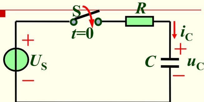
RC电路的零状态响应和零输入响应一样，都是按指数规律变化，显然这个暂态过程是电容元件的充电过程：充电电流 $i_C$ 按指数规律衰减；电容电压 $u_C$ 按指数规律增长，用曲线可描述为：
