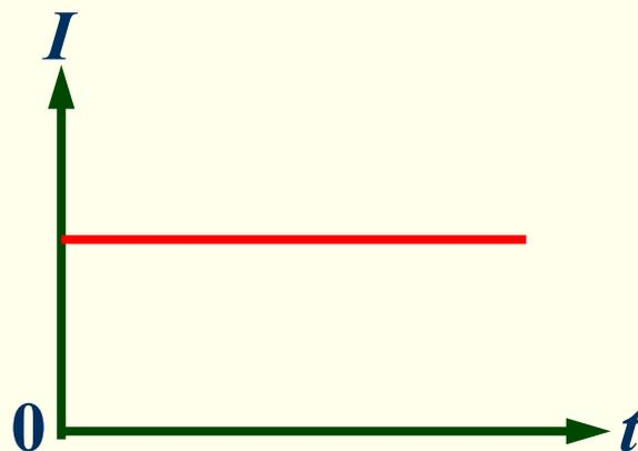
电阻元件是耗能元件，其电压、电流在任一瞬间均遵照欧姆定律的即时相应关系。所以，电阻元件上不存在暂态过程。
