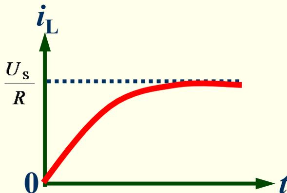
电感元件是储能元件，其电压、电流在任一瞬间均遵照微分(或积分)的动态关系。它储存的磁能：
