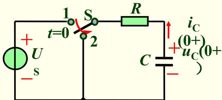
根据RC零输入响应电路可列写出电路方程为：
