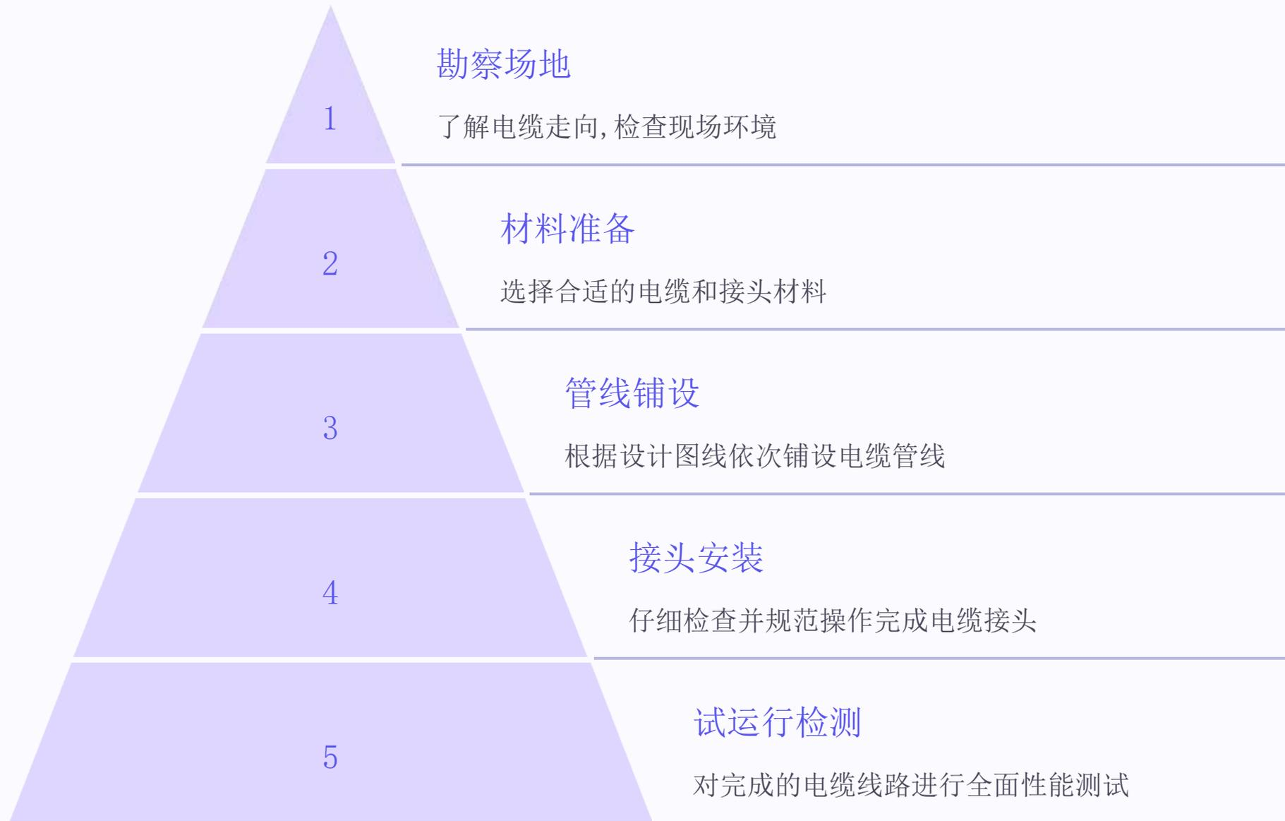
电缆连接工程的工艺流程主要包括现场勘察、材料准备、管线铺设、接头安装以及试运行检测等关键步骤。每个步骤都需要严格的质量控制和安全管理, 确保电缆连接工程顺利完成。
