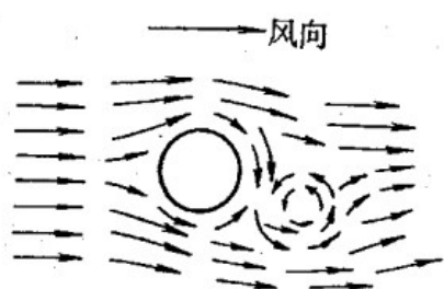
图 2-3 架空线背风面 涡流示意图
