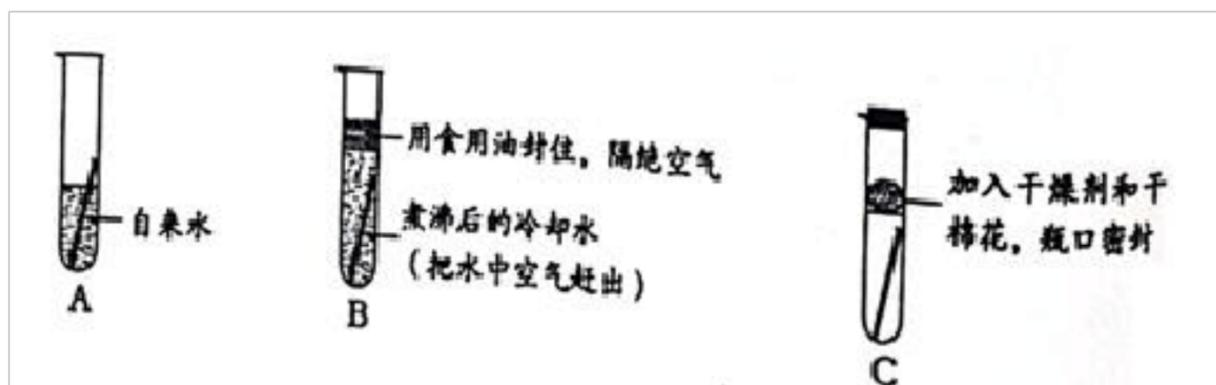
铁在生活中常见的现象，全世界每年由于生锈损失的钢铁约占世界年产量的四分之一。这是用于研究“铁生锈和水与空气关系”的一个实验装置。
