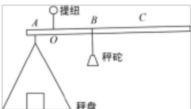
3. 据《杭州日报》报道,2001年6月22日,在杭州动物园,一位物理老师利用杠杆原理,仅用小小的弹簧测力计称出了一头大象的质量,如图甲所示.测量时利用了一根长度为12m的槽钢作为杠杆(如图乙).吊钩固定于钢槽的中点O.当钢槽水平静止时,弹簧测力计示数 $F_1$ 为200N,测得动力臂 $L_1$ 为6m,阻力臂 $L_2$ 为4cm,若不计槽钢和铁笼的质量,试估算大象的质量.( $g$ 取10N/kg)
