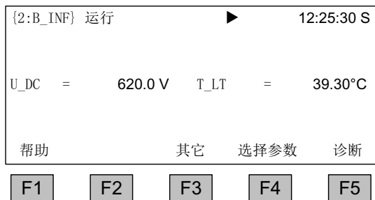
图 4-3 操作屏幕 - 示例：通过基本整流柜馈电
