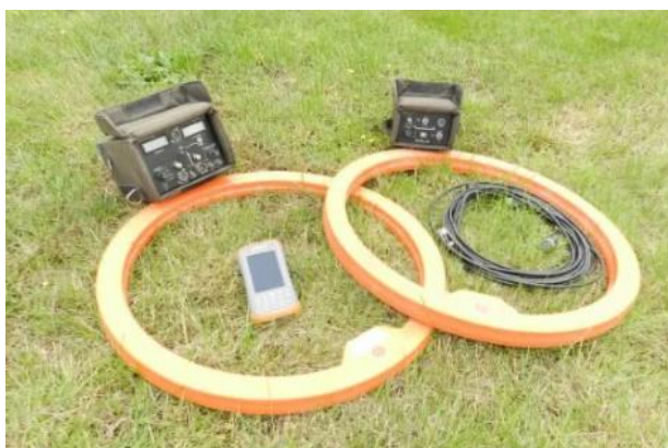
图 1.1 EM34 探测仪器
