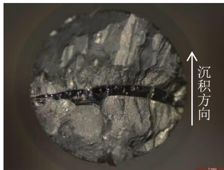
图3 激光定向能量沉积成形钛合金断口处的层状未熔合缺陷
