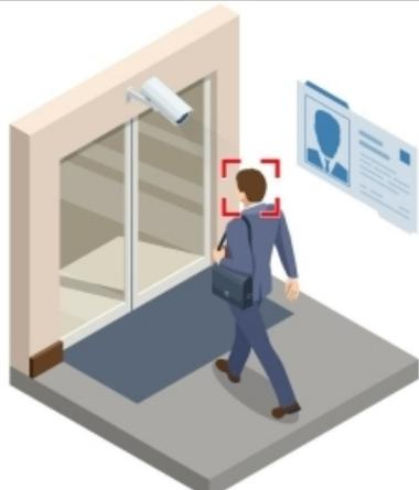
人脸识别摄像头通常具备自动对焦、自动曝光、自动白平衡等功能，以确保在不同光线条件下都能获得高质量的人脸图像。
