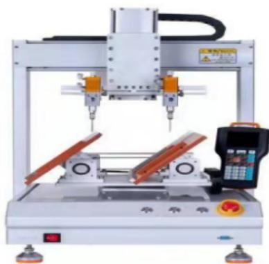
图 2-1 龙门固定结构点胶机实物图
