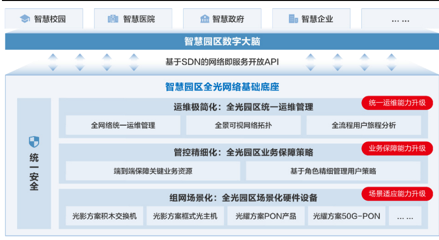
图 2：新华三园区全光有线通信网络架构
