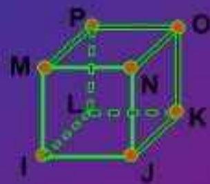
三维实体热单元 TEMP
