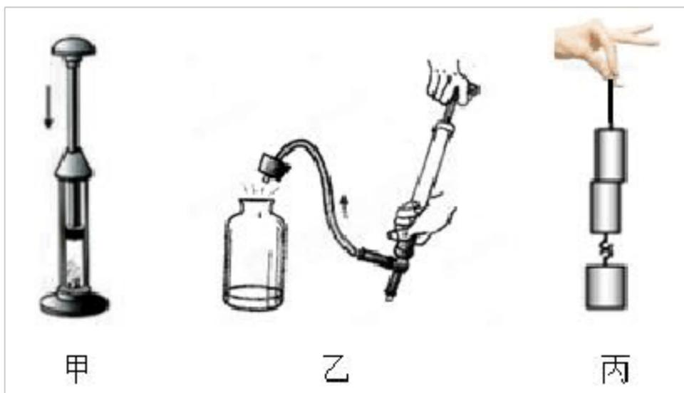
(1) 甲图：活塞压缩空气做功，空气的内能\_\_\_\_\_， 温度升高，达到硝化棉的燃点。
