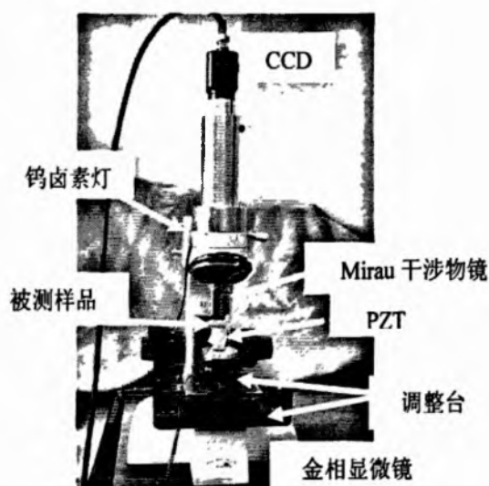
图 2.10 在金相显微镜基础上搭建的 Mirau 型白光垂直扫描系统
