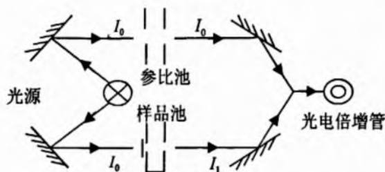
图 1.2 光度法基本原理图
