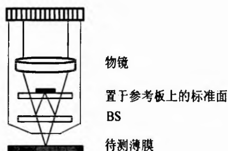
图 2.19 Mirau 干涉显微镜原理结构图
