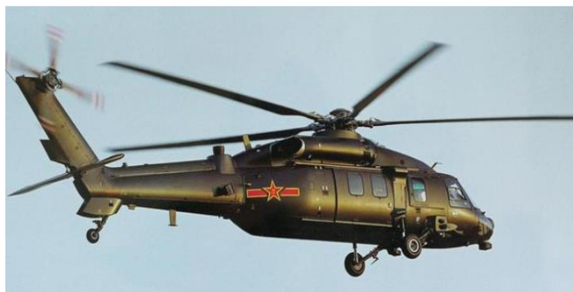
图表21：我国新一代武装直升机已应用 T800 复材，用量超 50%
