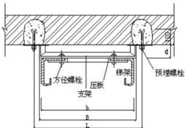
图 12.3.1.5. (2-2) 钢支架预埋地脚螺栓安装
