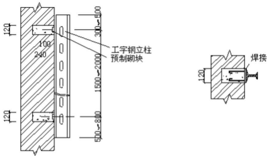
图12.3.1.5(4a)工字钢立柱用预制砌块侧装
