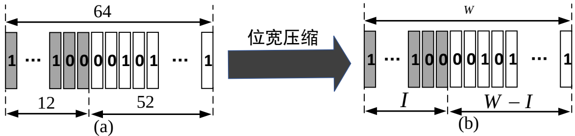
图 3-3 位宽压缩示意图
