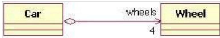
图中清楚的表明了类 Car 对象包含了另一类 Wheel 的 4 个实例，这两者在概念上是密不可分的，其中的一个类是另一个类的构成成分。菱形表示“包含”，箭头表示被包含的对象，数字 4 表示包含的数目。
