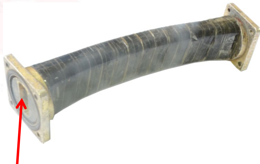
内壁镀一层铜、用硅橡胶 /聚硫密封胶制作的矩形波导
