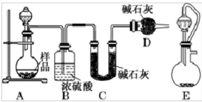
①实验前先检查装置的气密性，并称取一定质量的样品放入A中，将稀硫酸装入分液漏斗中。D装置的作用是\_\_\_\_\_。
