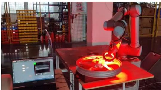
图 3-6 基于机械臂控制的工件检测系统实物
