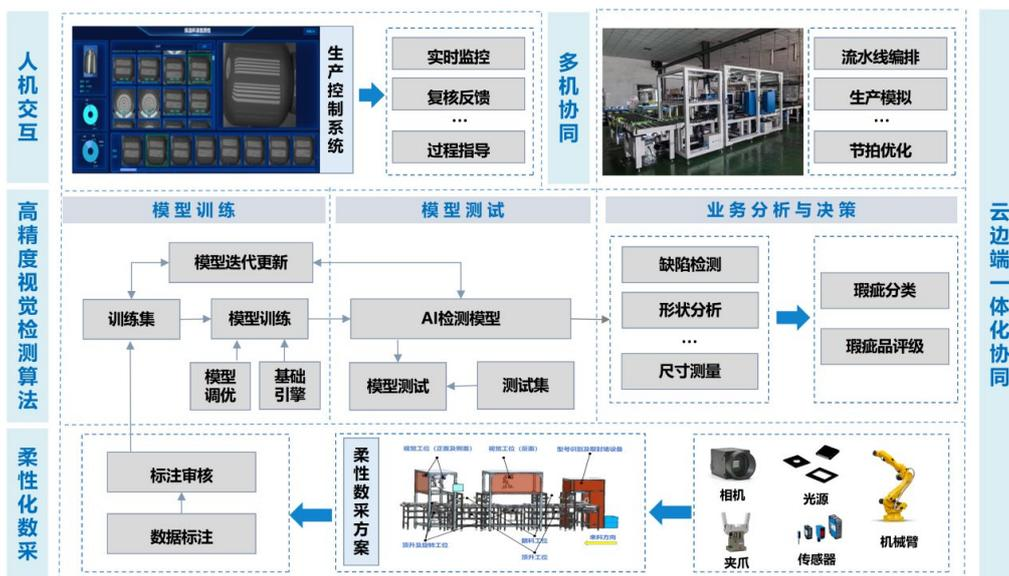
图 3-1 高精度工业视觉检测关键技术体系
