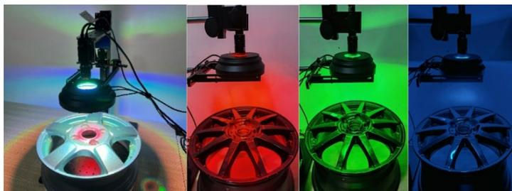
图 3-4 基于波长适配的工件图像采集系统实物
