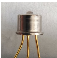
图 2-6 雪崩光电二极管实物图
