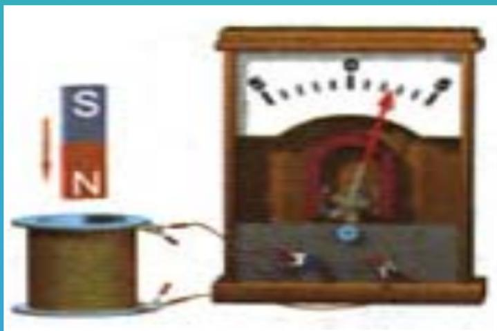
感应电动势的大小由穿过电路的磁通量的变化的快慢（即磁通量的变化率的大小  $\Delta\phi / \Delta t$ ）决定。
