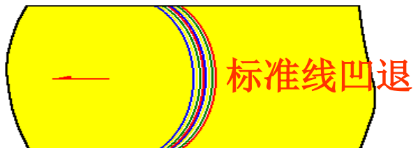
图5-8 毛毯标准线变形—凹退
